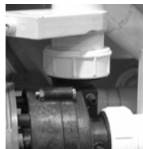
Vanne guillotine et raccord-union de la pompe
