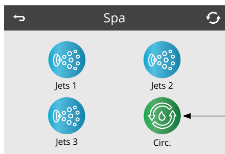
Pompe de circulation
